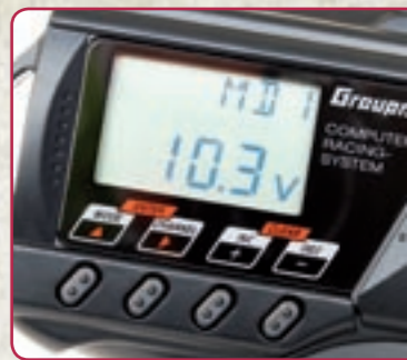
Die LED-Anzeige informiert nicht nur über das gewählte Modell (hier: MD 1), sondern schafft auch Gewissheit über den momentanen Akkustand
