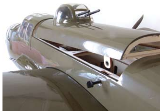
Durch die große Öffnung auf der Oberseite des Rumpfs kann man bei der Montage des Modells die vier Kunststoffschrauben zur Befestigung der Tragflächen, das Akkufach und die zu verbindenden Stecker und Buchsen gut erreichen. Für die Aufrüstung des Modells benötigt man kein Werkzeug. Die große Klappe auf der Oberseite des Rumpfes wird vorn durch eine Holzlasche und hinten durch zwei Kunststoffschrauben sicher gehalten und ist nach der Montage unauffällig
