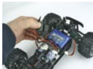
Nach dem Abnehmen von nur drei Karosseriedipsen hat man Zugang zum Fahrakku
