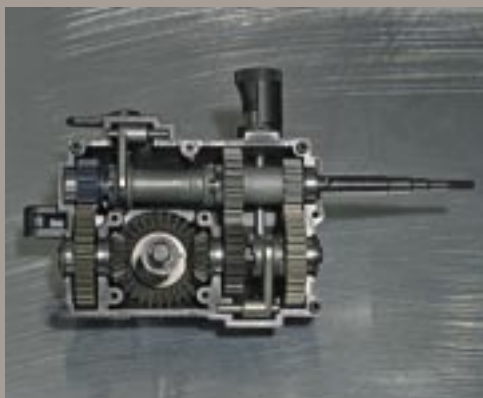
Das Innenleben der zweistufigen Getriebebox: Schon der LST1 war mit dieser hervorragend funktionierenden Einheit versehen
