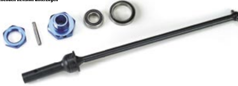
Augenscheinlichste Änderungen: leichtere Räder (links) und neue Radträger samt größerer Lager und neuer Kardanwellen. Auch die Radmitnehmer wurden einer eingehenden Revision unterzogen
