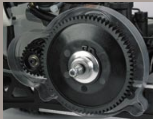
Der neue zweiteilige Lexan-Schutz für das Zweigang-Getriebe lässt praktisch keinen Schmutz mehr an dieser Stelle eindringen
