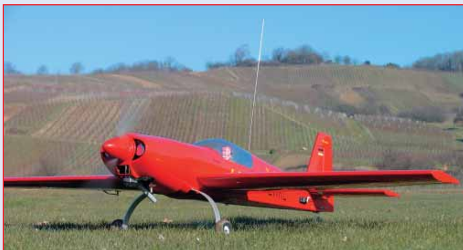
So hatte ich mir die Frontansicht vorgestellt: Die beiden Kammern des Doppeltopf-Dämpfers sitzen genau hinter den Lüftungsöffnungen der Motorhaube, was für optimale Kühlung sorgt, und der polierte Dämpfer animiert die Augen der Betrachter immer wieder aufs Neue
