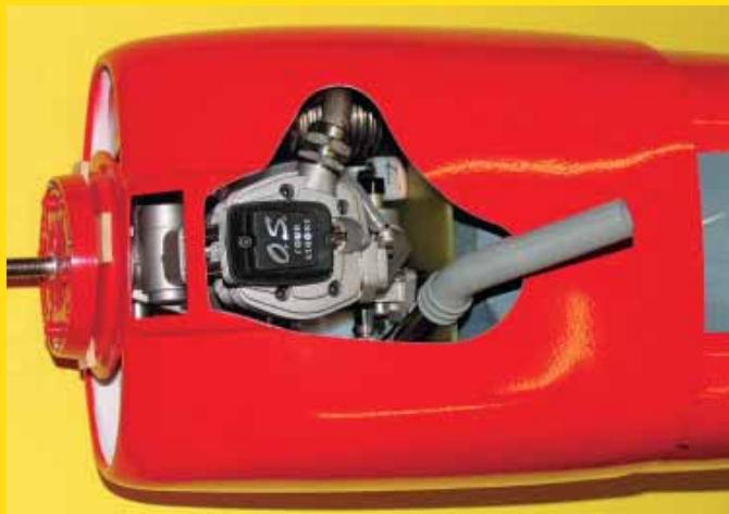
Sind dann die Lüftungsöffnungen schon mal grob in die Motorhaube eingebracht, schiebt man die Haube mit immer noch montierter Grundplatte auf die Motorwelle auf und kann nun diese Einheit mit der Kurbelwelle verschrauben. Anschließend bringt man die seitlichen Befestigungsbohrungen in der Haube und am Rumpf an. Demontiert man anschließend die Spinnergrundplatte und die Abstandsklötzchen, so freut man sich über einen perfekten umlaufenden Spalt von genau 2 mm zwischen Haube und Spinner
