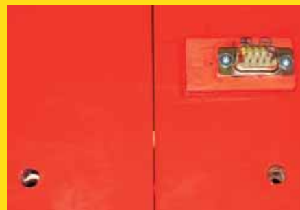
Bei zusammengescho-benen Flächenhälften sorgen die beiden Schrauben, welche durch die Bohrungen den Flügel am Rumpf halten, dafür, dass sich die Flächenhälften nicht mehr verschieben können
