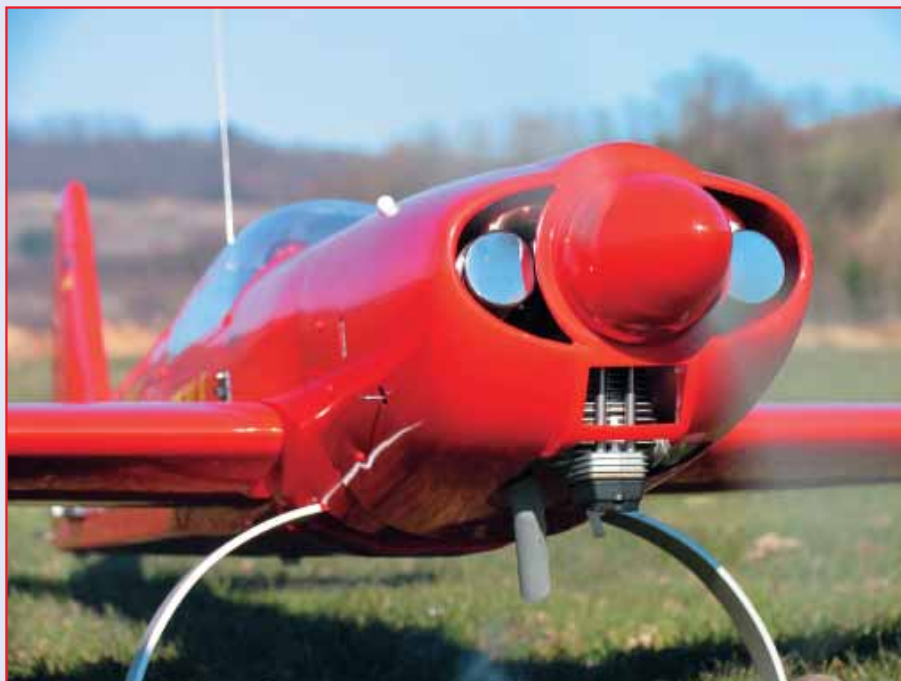
So hatte ich mir die Frontansicht vorgestellt: Die beiden Kammern des Doppeltopf-Dämpfers sitzen genau hinter den Lüftungsöffnungen der Motorhaube, was für optimale Kühlung sorgt, und der polierte Dämpfer animiert die Augen der Betrachter immer wieder aufs Neue
