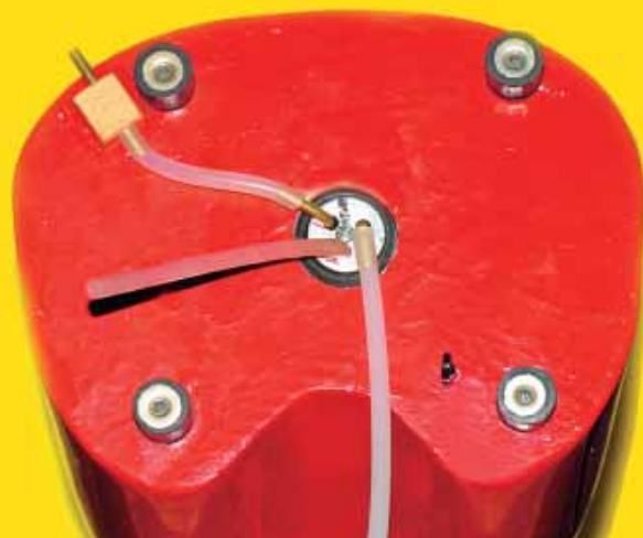
Die Schwinggummis sind im maximal möglichen Abstand platziert. Aus dem Tankkopf treten die Schläuche für Befüllen, Vergaserzu- und Überlauf heraus. Da der graue Lack am Kopfspann und im Schacht nicht spritfest war, wurde er zunächst mit dünnflüssigem Sekundenkleber versiegelt und anschließend mit rotem Autolack überlackiert
