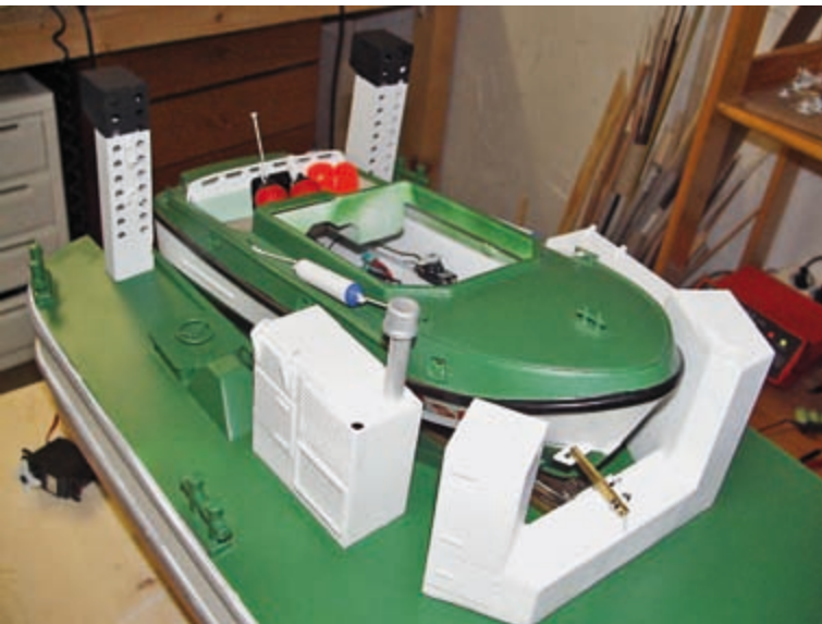
Den querstehenden Kasten mit dem Fangarm für das Tochterboot habe ich mit Doppelklebeband befestigt. Der Kasten wird erst festgeklebt, nachdem die Funktion des Tochterbootaufzuges endgültig eingestellt ist
