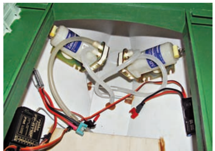
Eine Pumpe ist für den Löschmonitor vorgesehen, die zweite als Imitation des Schottelpumpjets
