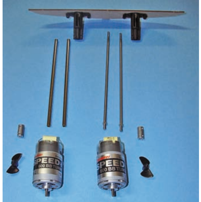
Vor der Montage der Antriebseinheit werden alle dazugehörigen Teile in ihrer Position angeordnet
