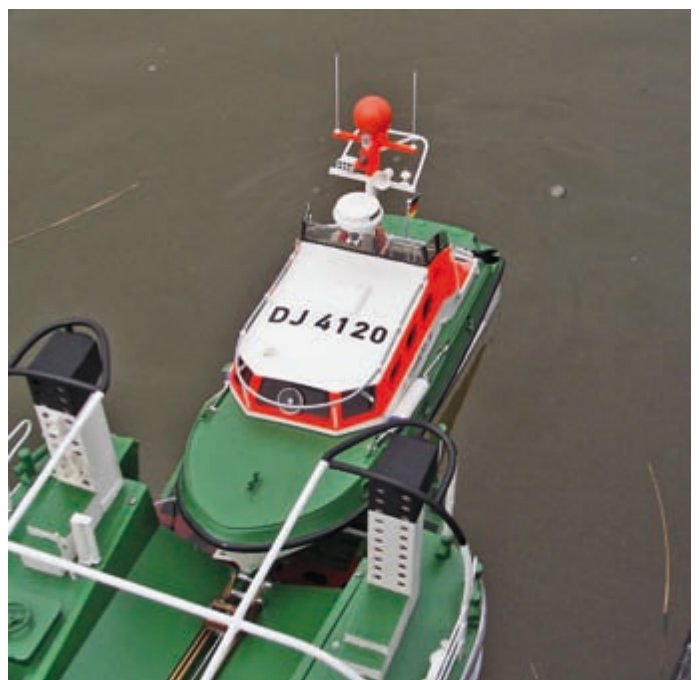
Bei der Wiederaufnahme fiel auf, dass die Heckwanne nicht tief genug im Wasser liegt
